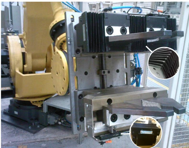
Acessórios para alta velocidade podem ser aplicados nas proteções sanfonadas, como roletes, pantógrafos, limitadores tipo cinta, etc., para atender as mais variadas e severas condições de trabalho.
